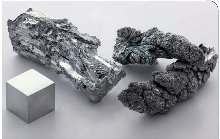
Kristallijne (links) en gesublimeerd dendritische vorm van zink.
